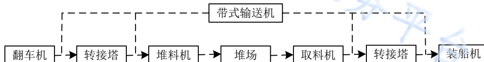
图1 煤炭装船码头运转流程
